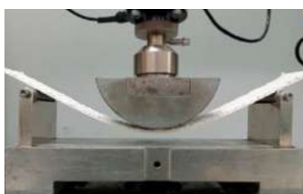
Полимерная штукатурка (например, СТ 74) Механическое воздействие на высокоэластичную полимерную штукатурку
