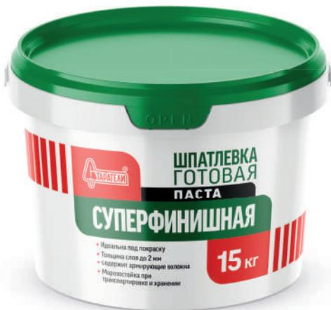
Применяется для тонкослойного суперфинишного выравнивания стен и потолков внутри помещений с нормальным уровнем влажности в случаях, когда к качеству получаемого покрытия предъявляются повышенные требования. Заполняет мельчайшие неровности, идеально подходит для шпатлевания ультратонким слоем («на сдир»), приклейки стеклохолста, заделки стыков ГКЛ, ГВЛ с использованием армирующей ленты.
